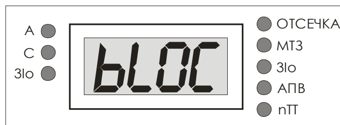
Рисунок 5. Отображение режима «Блокировка».
