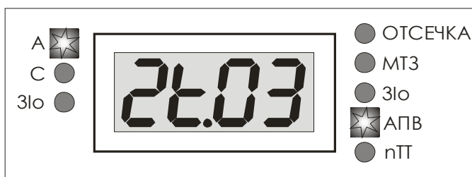
Рисунок 15. Выбор двухступенчатого АПВ.
