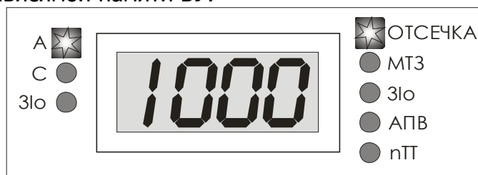
Рисунок 7. Редактирование уставки токовой отсечки.
