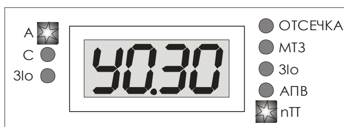
Рисунок 19. Выбор задержки срабатывания выхода УРОВ.
