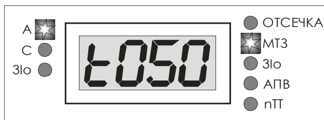
Рисунок 9. Установка времени срабатывания МТЗ.
