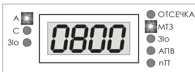
Рисунок 8. Редактирование уставки МТЗ.
