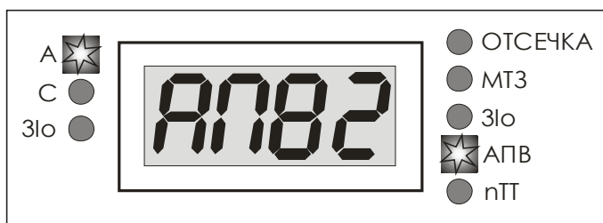
Рисунок 15. Выбор двухступенчатого АПВ.
